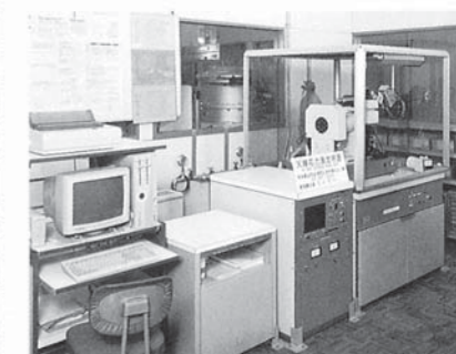
PSPC微部应力测量装置
