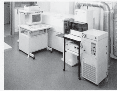
电感耦合高频等离子体发光分析装置
