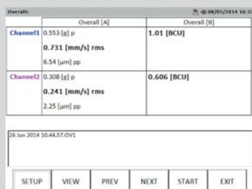
双通道实时通频值测量 (带通/BCU)
